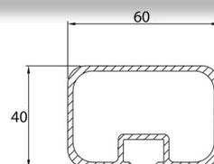
Torlicht aus Aluminiumprofil 60x40 mm.
